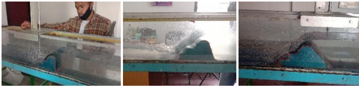
a) b) c) Gambar 2. Simulasi aliran pada saluran dengan variasi kemiringan mercu bendung pada: a) 3:0, b) 3:1, c) 3:3
