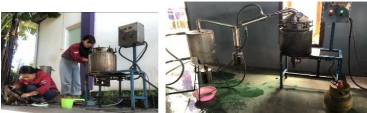
Gambar 3. Perakitan alat pirolisis
