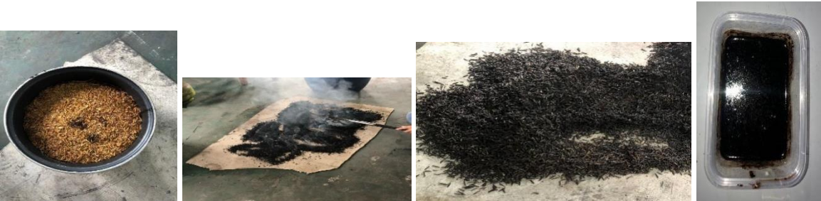
Gambar 2. Hasil bioarang menggunakan peralatan uji a) bahan baku sekam padi, b), c) hasil pirolisis, d) asap cair
