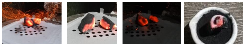
Gambar 8. Pengujian waktu nyala sampel briket arang pada perbedaan mesh a) 40, b) 50 dan c) 60
